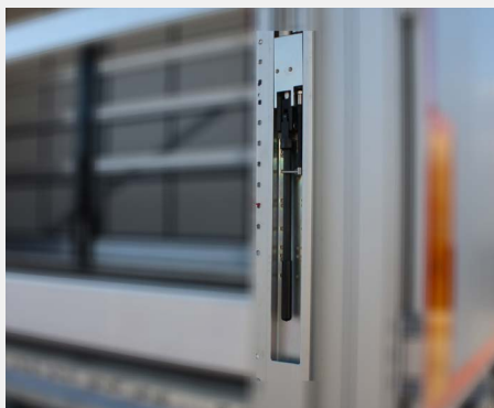
Sistema hidráulico de elevación del techo.
