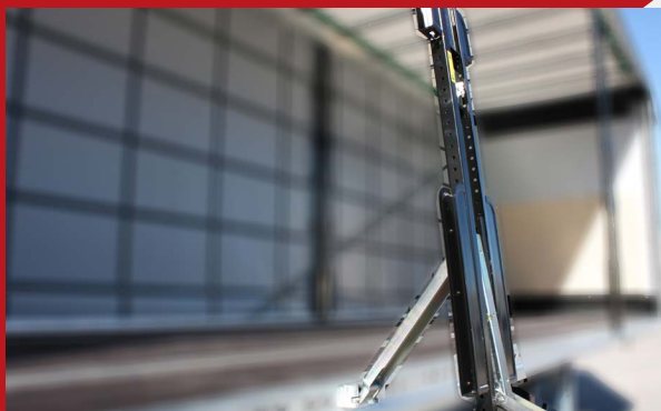
Pilares ajustables variante techo.
