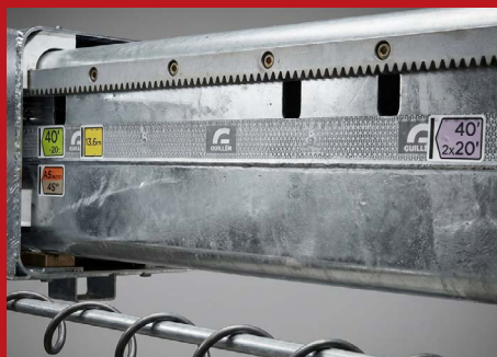
Sistema extensión trasera mediante cremallera.
