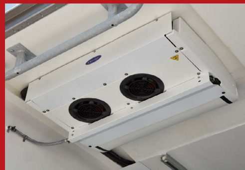
Evaporador interior Multi Temp encastrado con protector galvanizado en caliente.
