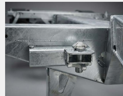
Twist-lock desmontable Front Extension para anclaje inferior contenedores no H.C (sin tunnel).
