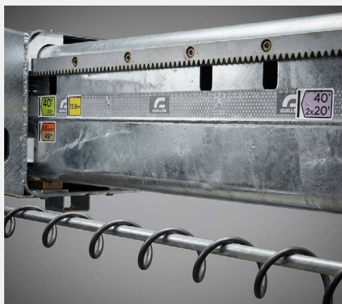
Sistema extensión trasera mediante cremallera.
