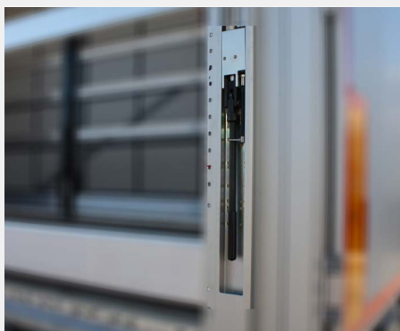
Sistema hidráulico de elevación del techo.
