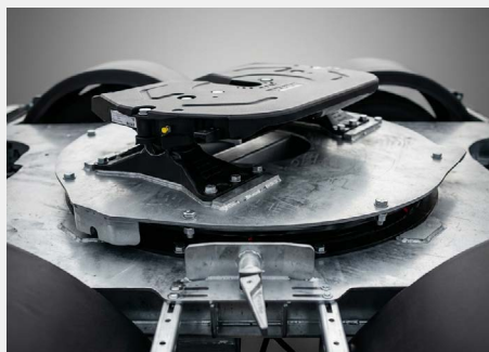
5º Rueda montada sobre corona giratoria de bajo mantenimiento con bloqueo manual para maniobras.
