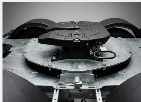
5º Rueda montada sobre corona giratoria de bajo mantenimiento con bloqueo manual inhabilitado para maniobras.
