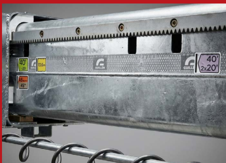
Sistema extensión trasera mediante cremallera.
