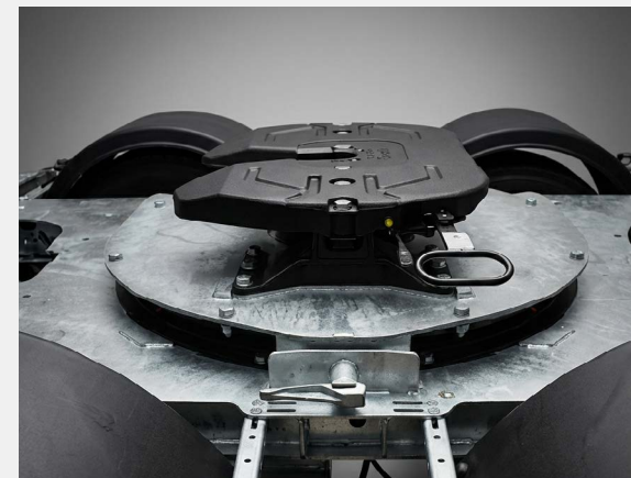
5º Rueda montada sobre corona giratoria de bajo mantenimiento con bloqueo manual inhabilitado para maniobras.
