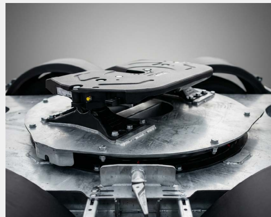
5º Rueda montada sobre corona giratoria de bajo mantenimiento con bloqueo manual para maniobras.
